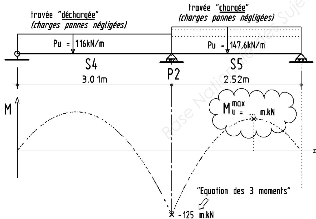
Le moment sur l'appui intermédiaire "P2" a été déterminé en appliquant "l'équation des 3 moments" à ce schéma mécanique:  $M_{p2} = -125 \text{ m.kN}$
