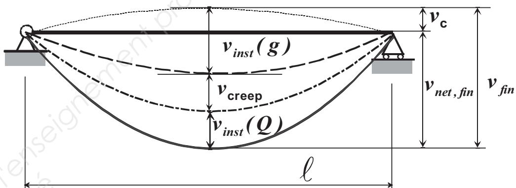
flèche instantanée due aux charges variables :  $v_{inst}(Q)$ , part de la flèche instantanée due uniquement aux actions variables.
