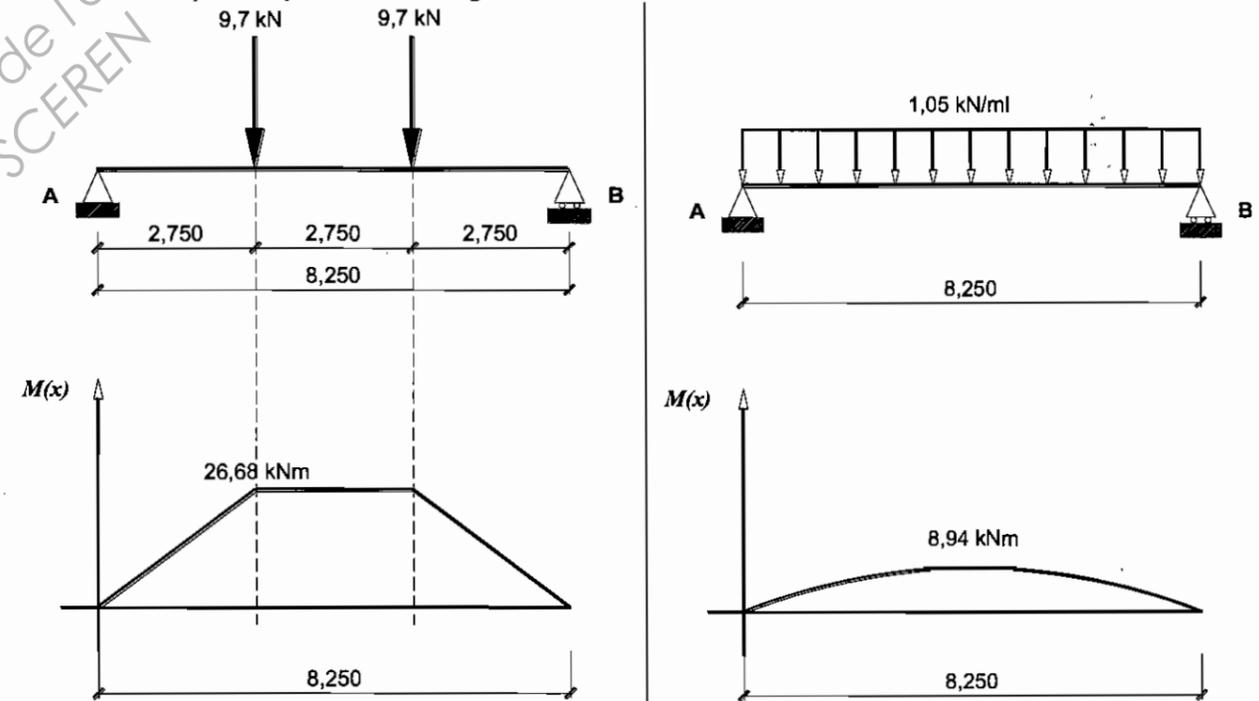
⇒ En utilisant le théorème de Müller Breslau et le tableau des intégrales de Mohr, calculer la flèche au milieu de la poutre.
