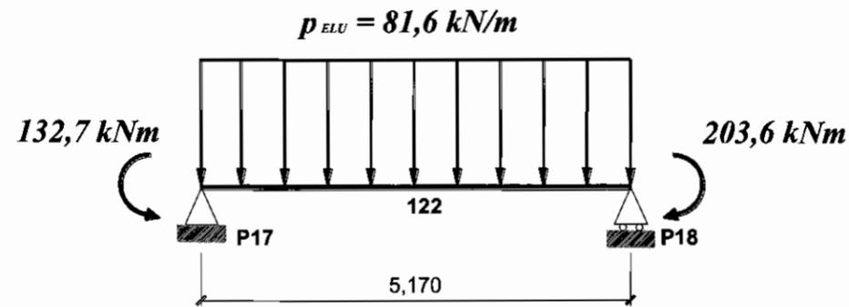
⇒ Sur le **DR1**, tracer précisément le diagramme de moment fléchissant dans la travée 122.
